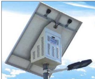
Nella versione fotovoltaica, sono dotate di una speciale centralina elettronica che, oltre, a gestire l'accensione automatica al tramonto e lo spegnimento della stessa all'alba (funzionamento crepuscolare), è in grado di ridurre automaticamente il flusso luminoso (dopo 4/5 ore dall'accensione e fino a 5 gradini di riduzione programmabili e personalizzabili), in accordo alla tensione di batterie, al
